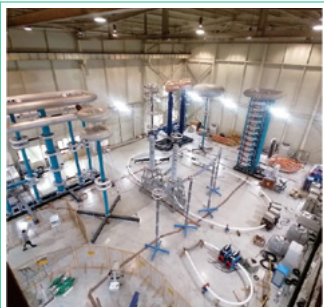
▲ 320kV HVDC Type Test 선로
