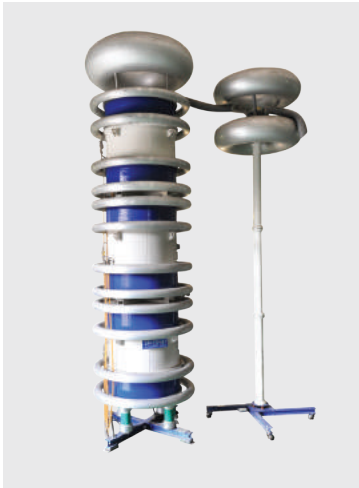
AC 내전압 시험기 (최대 900kV)
