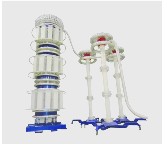
AC 내전압 시험기 (최대 750kV)
